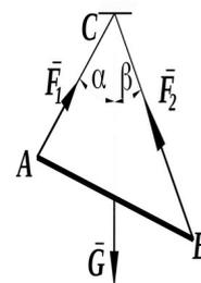
Определить вес балки АВ (Н), если известны силы натяжения веревок  $F_1 = 120$  Н и  $F_2 = 80$  Н. Заданы углы  $\alpha = 45^\circ$  и
