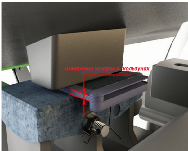
Измерение зазора между скользунами
