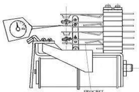
Выполняем измерение механических параметров реле с помощью. Щупов и микрометра. измеренные параметры фиксируем в журнале, установленного образца.
