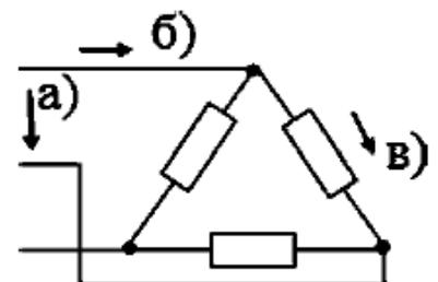
Вопрос № 123. На схеме «треугольник» линейный ток обозначен
