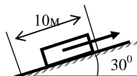
9. Лебёдкой поднимают груз  $m=162\text{кг}$  со скоростью  $0,5\text{м/с}$ , мощность двигателя лебёдки 1 кВт. Определить общий КПД механизма.
