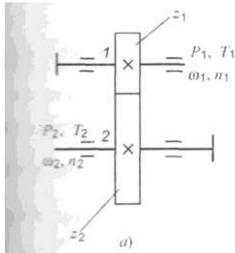
При вращении зацепленных зубчатых колес окружности диаметрами  $d_{w1}$  и  $d_{w2}$  перекатываются одна по другой без скольжения и называются начальными. У отдельного колеса начальная окружность не известна до тех, пока не известны парное колесо и межосевое расстояние  $a_w$ . Делительная окружность принадлежит отдельно взятому колесу и делит зуб на две
