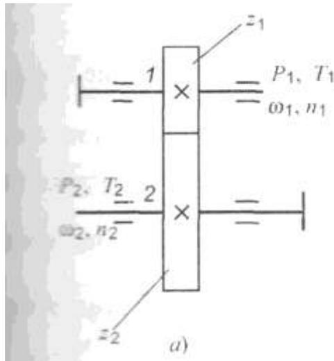
При вращении зацепленных зубчатых колес окружности диаметрами  $d_{w1}$  и  $d_{w2}$  перекатываются одна по другой без скольжения и называются начальными. У отдельного колеса начальная окружность не известна до тех пор, пока не известны парное колесо и межосевое расстояние  $a_w$ . Делительная окружность принадлежит отдельно взятому колесу и делит зуб на две части — головку высотой  $h_a$  и ножку высотой  $h_f$  при этом высота зуба  $h = h_a + h_f$  обозначается  $d$ .
