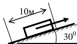
9. Лебёдкой поднимают груз  $m=162$ кг со скоростью 0,5м/с, мощность двигателя лебёдки 1 кВт. Определить общий КПД механизма.
