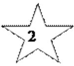
Что обозначает этот знак на шкале измерительного прибора? | 1.Предел измерения;<br>2.Напряжение испытания;<br>3.Категория размещения;<br>4.Место выпуска.                                                                                                                         |
