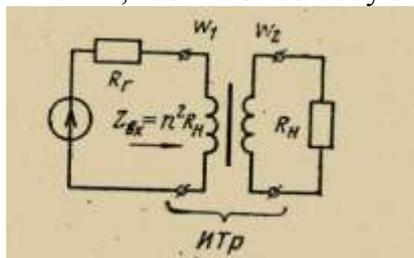
Параметры переходного трансформатора: 1) коэффициент трансформации(отношение числа витков первичной обмотки к числу витков вторичной обмотки). 2)Индуктивность обмоток. 3)Полное сопротивление для заданной полосы частот.
