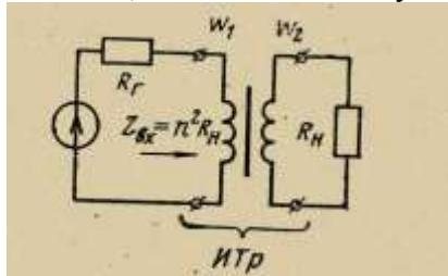
Параметры переходного трансформатора: 1) коэффициент трансформации (отношение числа витков первичной обмотки к числу витков вторичной обмотки). 2) Индуктивность обмоток. 3) Полное сопротивление для заданной полосы частот.
