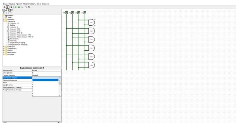
4) Добавим из каталога “Элементы” элемент “ИЛИ” на схему в количестве 1 штуки и выставим в характеристике данного элемента, количество входов исходя из количества элементов “И”, следовательно в нашем случае 6 штук.
