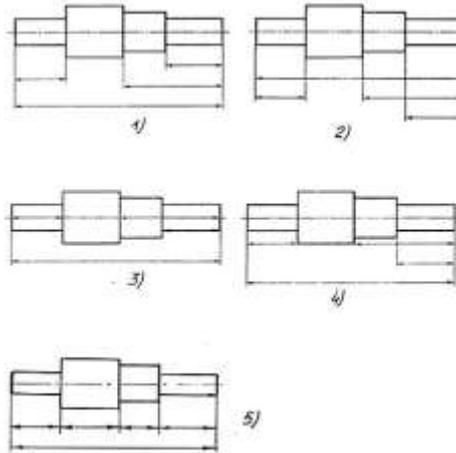
**Вопрос 11. На рисунке: показаны варианты правильных и ошибочных расположений размерных линий. Определите, под каким номером обозначен правильный чертеж:**
