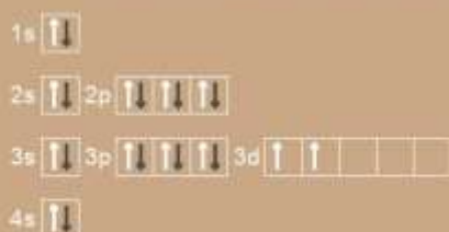
Электронно-графическая схема титана (Ti)
