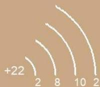
Электронно-графическая схема титана (Ti)
