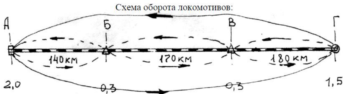
Рисунок 1 Схема участков обращения локомотивов (А - основное депо, Г - оборотное депо; Б и В - пункты смены локомотивных бригад)
