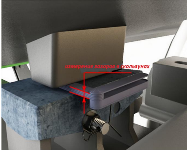
Измерение зазора между скользунами
