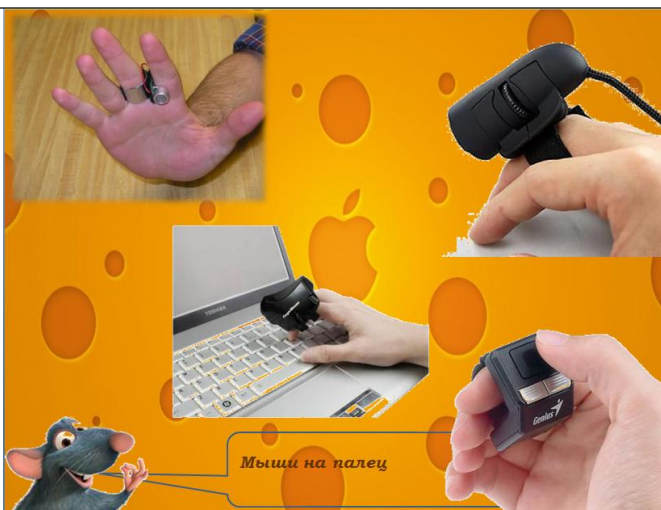
А эта мышь, по-моему, инопланетянин. Новое устройство управления компьютером крепится к запястью и двум пальцам: среднему и указательному. На внутренней стороне ладони располагается, привычный уже в компьютерных мышках, лазер, отслеживающий перемещение.
