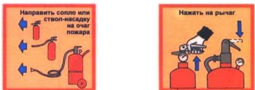
Используя рисунок, установите порядок действий при использовании огнетушителя.
