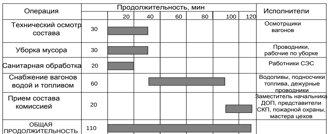
Рис. 2. График операций по обработке состава пассажирского поезда по обороту
