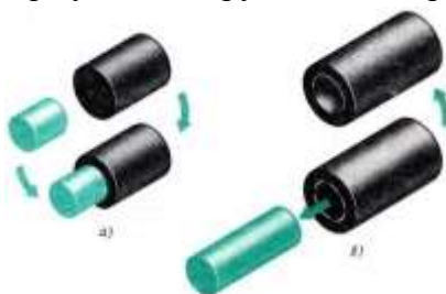
Рисунок 1 Деталь как сумма или разность геометрических тел
