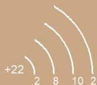
Распределение электронов в атоме титана (Ti)
