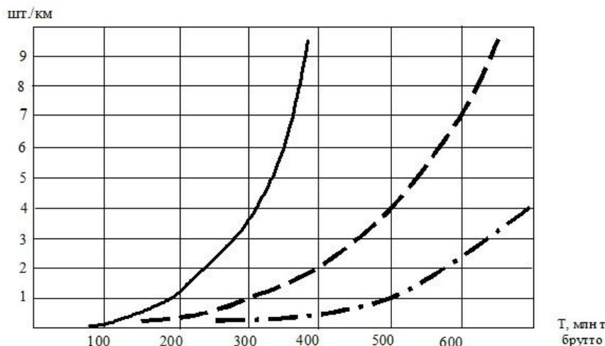
Рис. 1. Графики суммарного одиночного выхода рельсов от пропущенного тоннажа:
