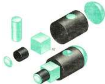
Рисунок 3 Анализ геометрической формы заготовки ключа: а - элементы детали; б - общий вид детали
