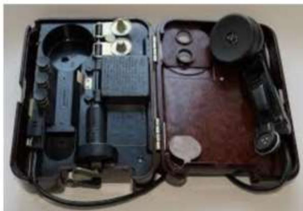
2. Это задание также выполняется согласно технологической карте. Необходимо произвести разборку телефонного аппарата. Открыть крышку, проверить наличие батареи, проверить целостность микрофонного шнура. Проверить наличие микрофона и телефона в микрофонной трубке. Проверить питание микрофона и телефона продуванием в микрофон и прослушивание его в телефоне. Пояснить процесс выполнения работ по сборке-разборке телефонного аппарата.
