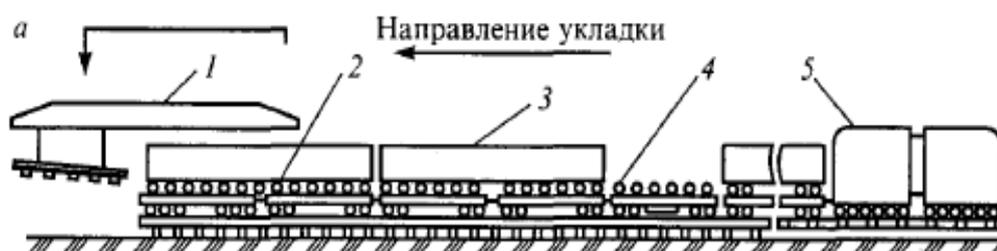
1 – кран укладочный, 2 –платформа с рольгангом, 3 – пакет звеньев, 4 - моторная платформа, 5 - локомотив
