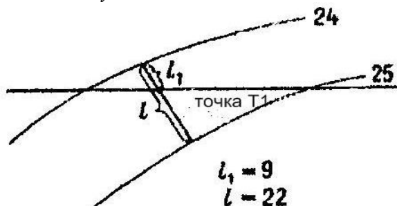
Рисунок 2 Схема для определения отметок земли для точки T_1 ,
